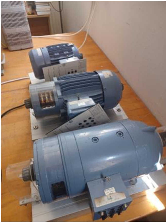
Εικ. 12 DC και τριφασικές μηχανές
