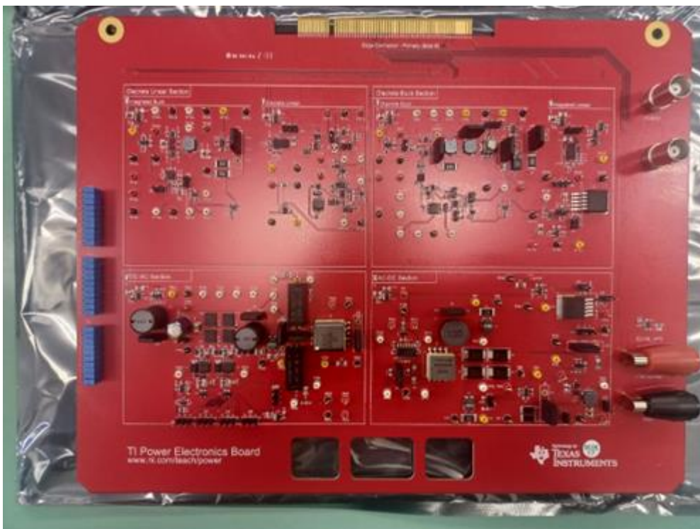
Εικ. 17 Εκπαιδευτική πλακέτα για μελέτη μετατροπών ισχύος.
