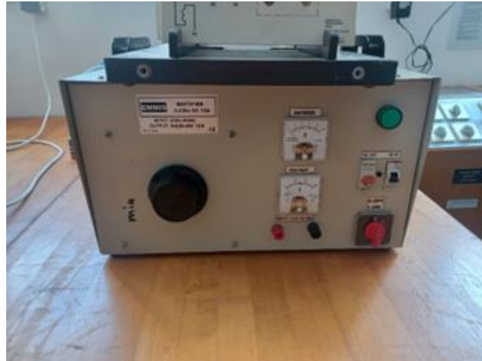
Εικ. 3 Απομονωμένο τροφοδοτικό DC τάσης
