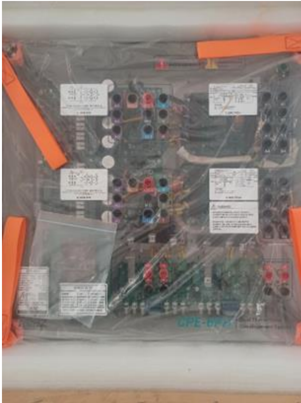
Εικ. 16 Διατάξεις προγραμματιζόμενων μετατροπών ισχύος για εκπαίδευση/έρευνα
