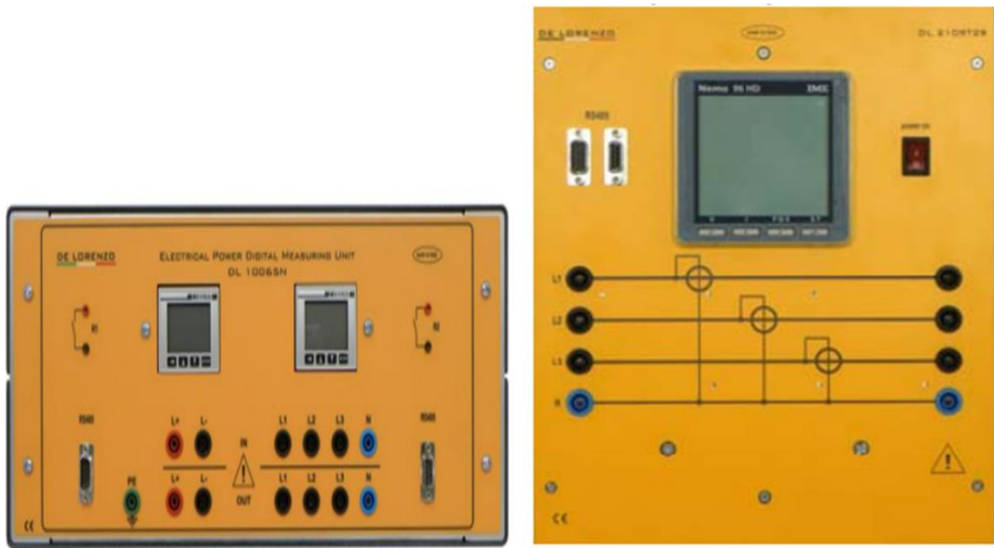
Εικ. 8 Επιτραπέζια μετρητικά συστήματα με αναλύτη αρμονικών
