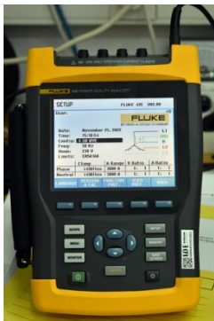
Εικόνα Αναλυτής ισχύος
