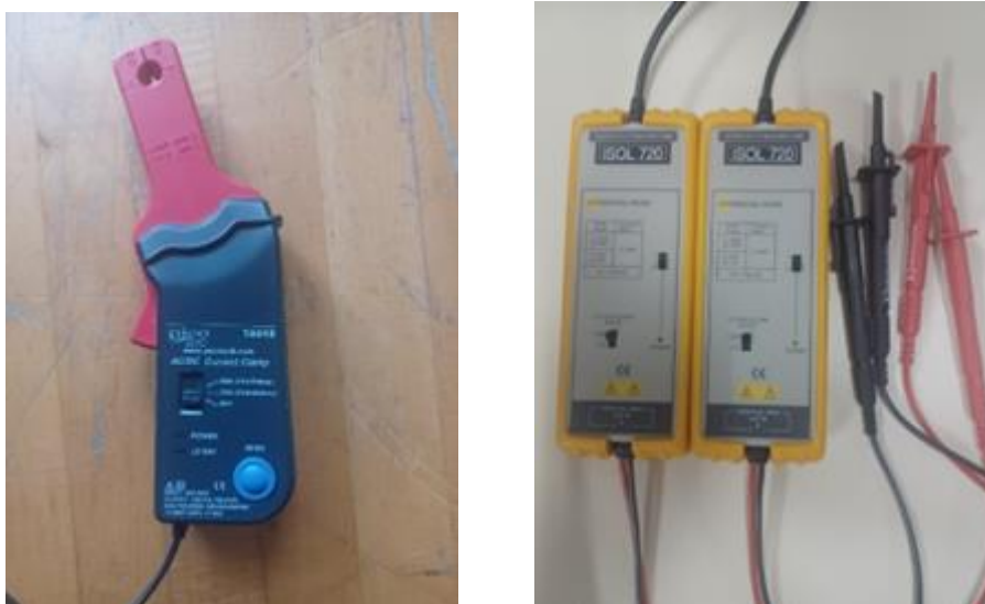
Εικ. 8 Όργανα χειρός (Αμπεροτσιμπίδα, ψηφιακό πολύμετρο)
