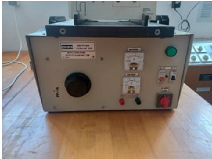
Εικ. 3 Απομονωμένο τροφοδοτικό DC τάσης
