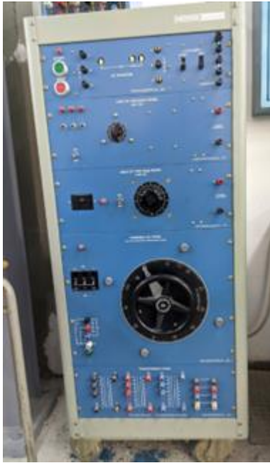
Εικ. 1 Τροφοδοτικό DC / 1φ AC / 3φ AC
