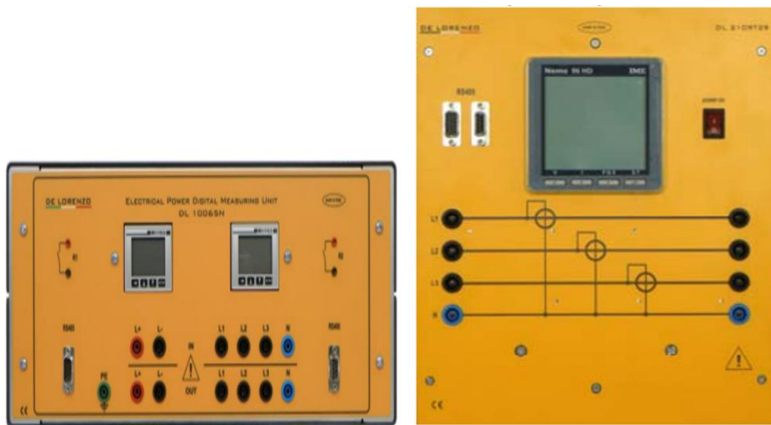
Εικ. 8 Επιτραπέζια μετρητικά συστήματα με αναλυτή αρμονικών
