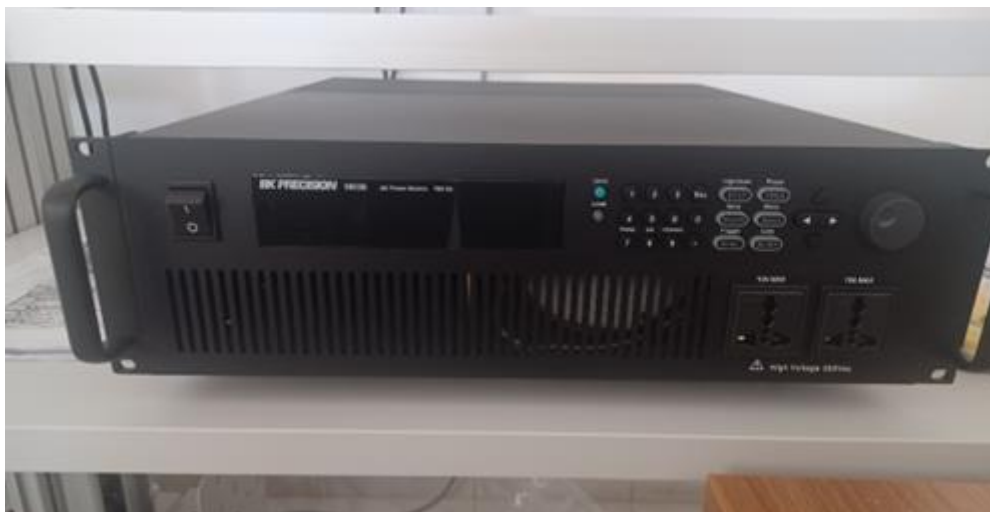
Εικ. 2 Προγραμματιζόμενη πηγή εναλλασσόμενης τάσης
