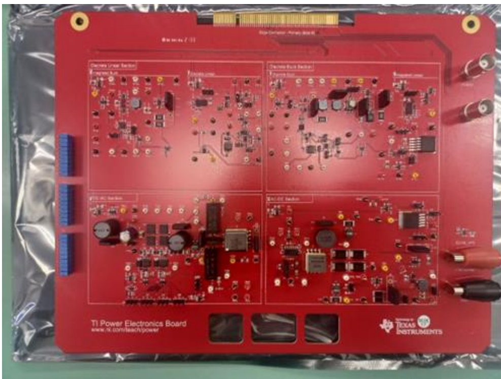
Εικ. 17 Εκπαιδευτική πλακέτα για μελέτη μετατροπών ισχύος.
