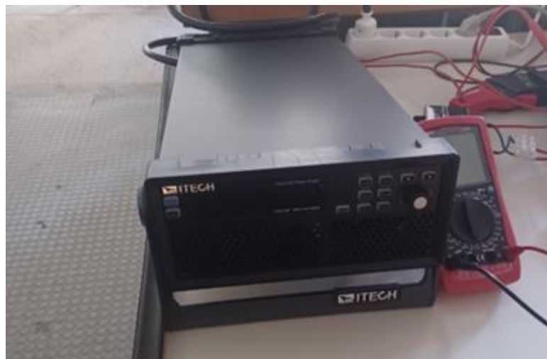
Εικ. 4 DC τροφοδοτικό 600 V/10 A/1850
